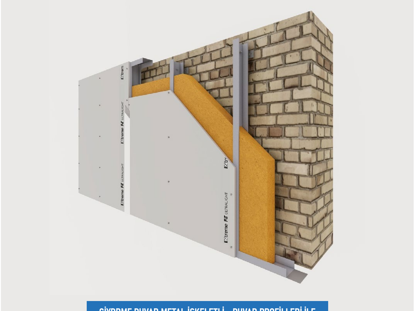
GİYDRME DUVAR METAL İSKELETLİ - DUVAR PROFİLLERİ İLE
